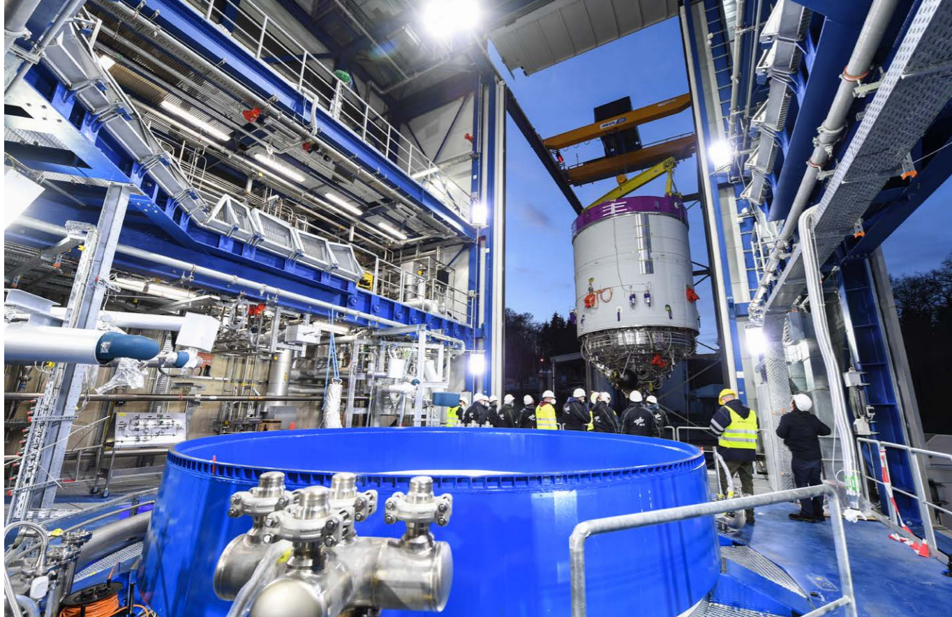
Die erste Oberstufe der Ariane 6 wurde am Prüfstand beim DLR Lampoldshausen erfolgreich getestet: Dabei testete das DLR-Team neue Komponenten auf ihre Funktionsfähigkeit. Die dadurch gewonnenen Erkenntnisse sind elementar, um die Ariane 6 startklar für den Weltraum zu machen.
