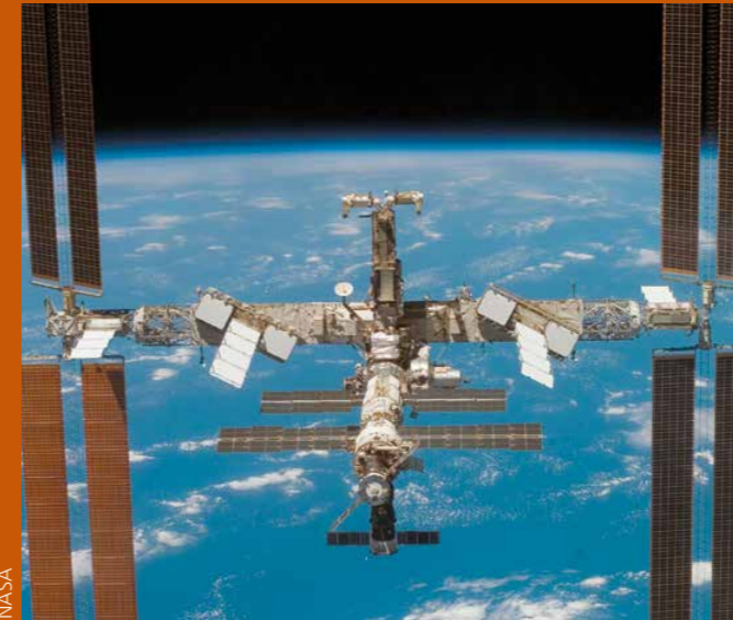
Juni 2007: Die ISS ist weiter gewachsen. Zu sehen ist die neue Gitterstruktur S3/S4. Das Bauteil besteht aus der Gitterstruktur S3 und dem Solarzellenträger S4.
