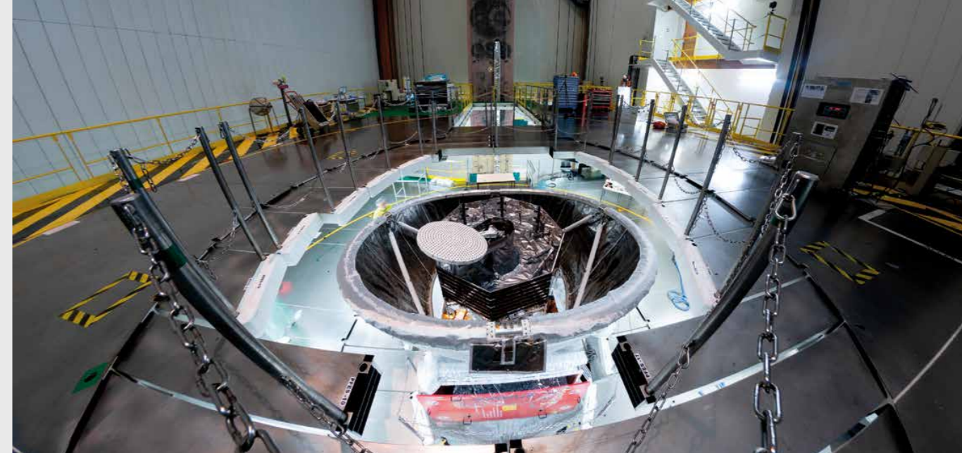
Gut verpackt: Kurz vor dem Start steckt das japanische MMO-Modul bereits in dem MOSIF-Schutzschild, um den hohen Temperaturen und dem extremen Teilchenbeschuss der Sonne zu trotzen.
