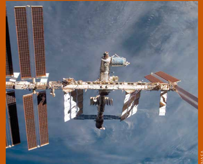
Februar 2008: Gut zu erkennen ist das europäische Weltraumlabor Columbus, das während der Shuttle-Mission STS-122 an die ISS angebaut worden ist.
