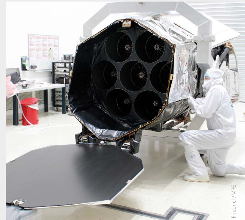
Das eROSITA-Flugmodell während der abschließenden Testkampagne: Der geöffnete Teleskopdeckel gibt den Blick auf die sieben Spiegelmodule frei. The eROSITA flight model during its final test campaign. The opened cover exposes the telescope's seven mirror assemblies.
