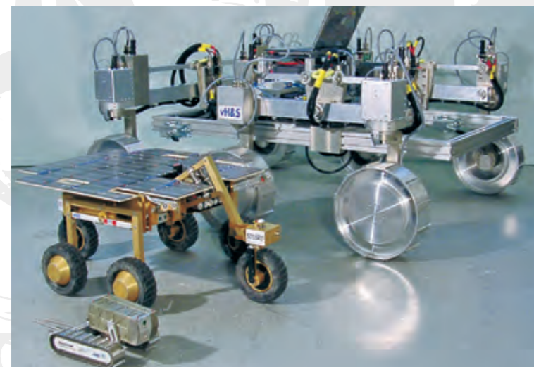
Die vH&S-Rover-Familie: Der Phase-B1-Rover wurde für die ExoMars-Mission entwickelt. Der Mini-Rover Solero ist extrem beweglich und dient als Konzept für autonome Exploration. Der Micro-rover "NANOKHOD" wurde für Extremsituationen gebaut und soll ebenfalls auf fernen Planeten zum Einsatz kommen.
