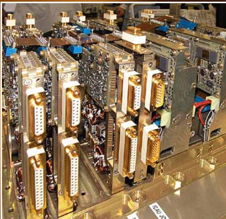
Die umfangreiche Hochspannungselektronik ist auf engstem Raum untergebracht. Das Gehäuse in Größe eines Schuhkartons beinhaltet Einsteckplatinen und Verbindungselemente.
