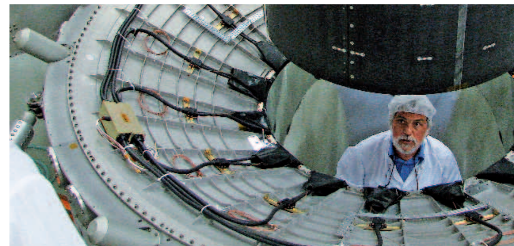
Stück für Stück wurde der Teilchendetektor von Technikern der Europäischen Organisation für Kernforschung (Conseil Européen pour la Recherche Nucléaire, CERN) in den AMS-02-Magneten integriert.
