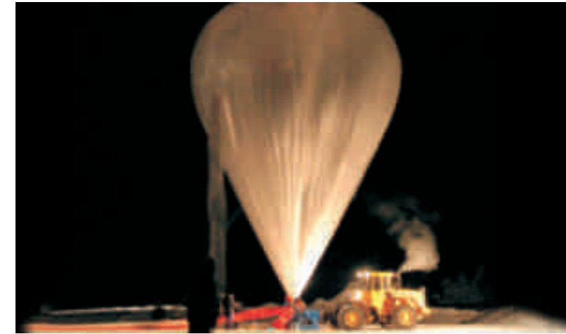
Start eines Validationsballons am 24. Januar 2010. Die Ballongondel trägt ein MIPAS-B Instrument zur Messung von Spurengasen unter anderem der für den Ozon-Abbau bedeutsamen Chlor-Oxide. (Karlsruhe-Institut für Technologie)
