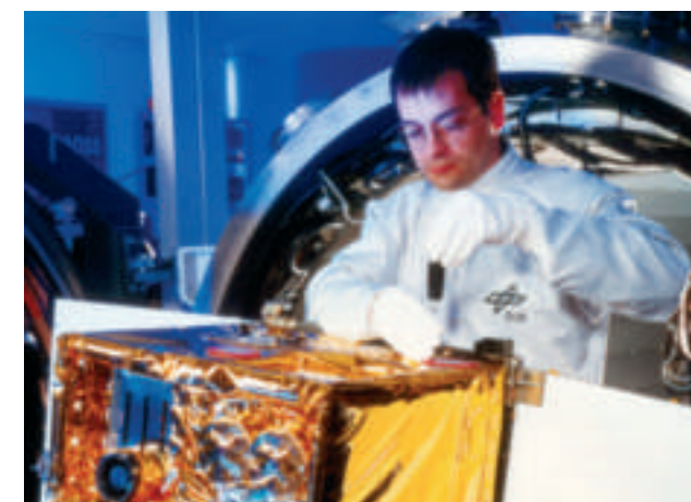
Der vom DLR entwickelte Satellitenbus BIRD im Labor
