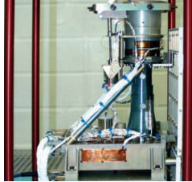
Die Framing Camera des DAWN-Satelliten (Max-Planck-Institut für Sonnensystemforschung)
